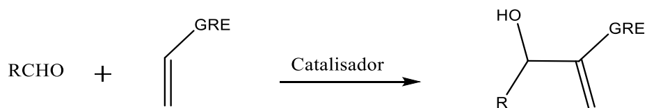
Figura 2 - Esquema geral da reação de Morita-Baylis-Hillman (MBH) entre um aldeído e um alceno com grupo retirador de elétrons (GRE).
