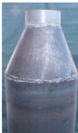
Figura 4 - Cone de conexão da câmara de combustão à chaminé.
