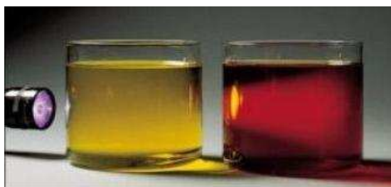
Figura 2.13: Dispersão da luz no recipiente de líquido vermelho devido a existência de partículas coloidais o que não é observado no outro recipiente, de líquido amarelado, que não é um sistema coloidal [37].
