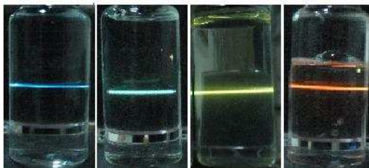
Figura 4.1: Fluorescência de algumas amostras de pontos quânticos coloidais, em cores distintas, excitadas com o laser UV. O frasco da esquerda contém apenas água mais detergente, já os demais contêm amostras de pontos quânticos de tamanhos diferentes.
