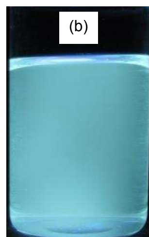
Figura 4.18: (a) Irradiância relativa versus comprimento de onda de emissão das amostras 19D' e 20D'; (b) Amostra 20D' que apresentou as melhores características entre as amostras com introdução de elemento Zn. Potência de saída do laser: 7,0 mW.
