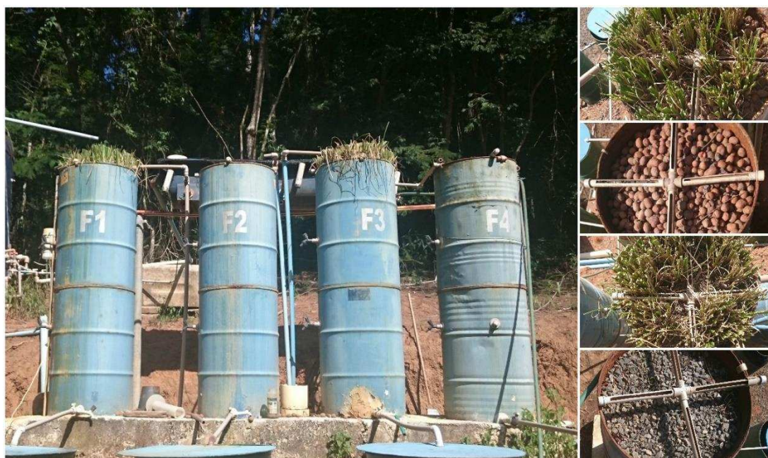
Figura 3.2. Filtros biológicos percoladores utilizados na pesquisa
