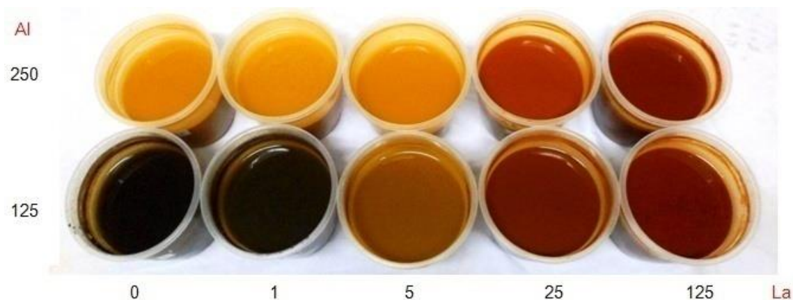
Figura 3 – Coloração das suspensões após agitação, no final do experimento (Relação Fe: Al: La = 500: y: x, y = valores dispostos na vertical, x = valores dispostos na horizontal).
