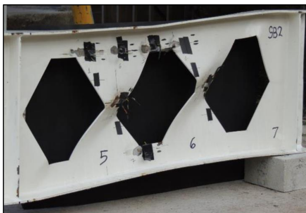
Figura 11 - Flambagem do montante de alma por cisalhamento.
