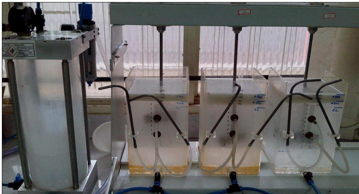
Figura 6: Flotatestes realizado com amostra de efluente bruto (Ind.A) de campanha preliminar.
