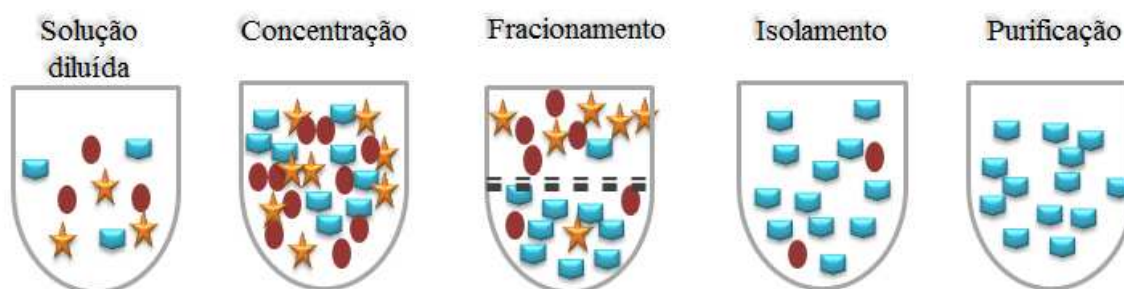
Figura 4 - Esquema dos processos de separação utilizados na indústria de alimentos. Quadrado, círculo e estrela representam sólidos solúveis, dispersos ou suspensos.
