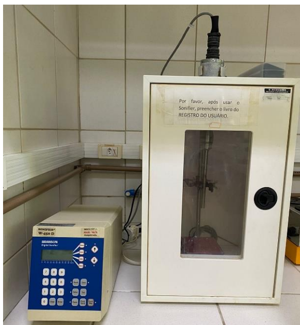
Figura 2 - Ultrassom modelo W-450 D (Sonifier®) utilizado para homogeneização da formulação e nanoencapsulamento do óleo essencial de alecrim-pimenta
