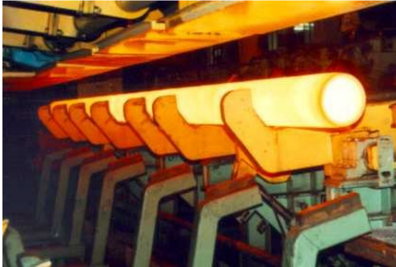
Figura 8 – Processo de laminação de barra.
