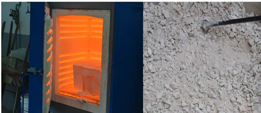
Figura 2.6 – Retirada dos blocos do forno e fragmentação do cimento
