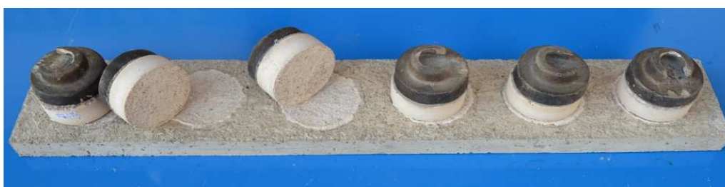
Figura 3.11 – Ensaio de resistência de aderência à tração
