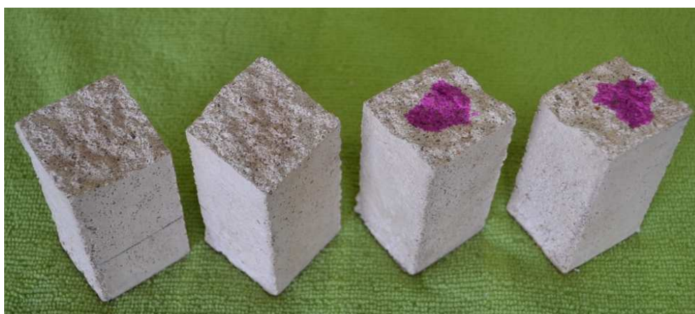
Figura 3.8 – Verificação da alcalinidade pela coloração do indicador fenolftaleína
