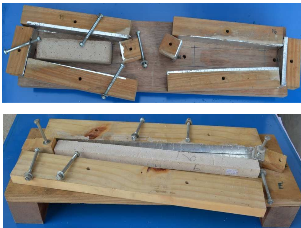
Figura 3.7 – Formas utilizadas na moldagem de corpos de prova e de barras
