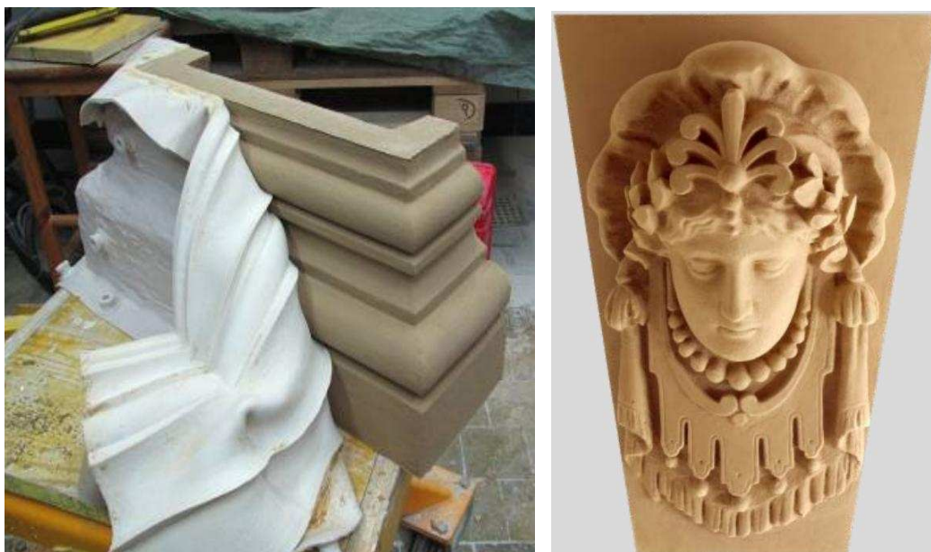
Figura 2.2 – Exemplos de ornatos moldados em cimento Romano para aplicação em restauro de edificação histórica
