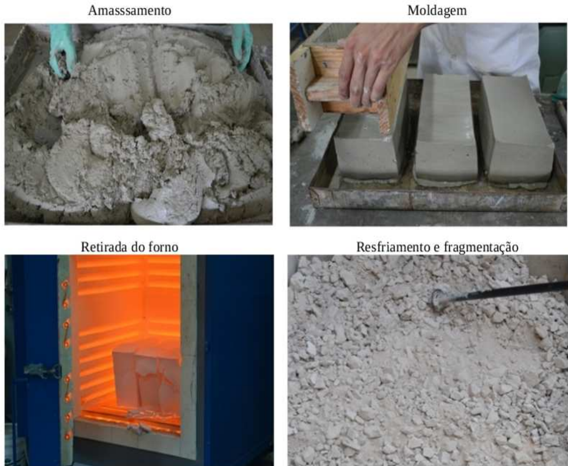
Figura 1.4- Processo de produção dos cimentos belíticos
