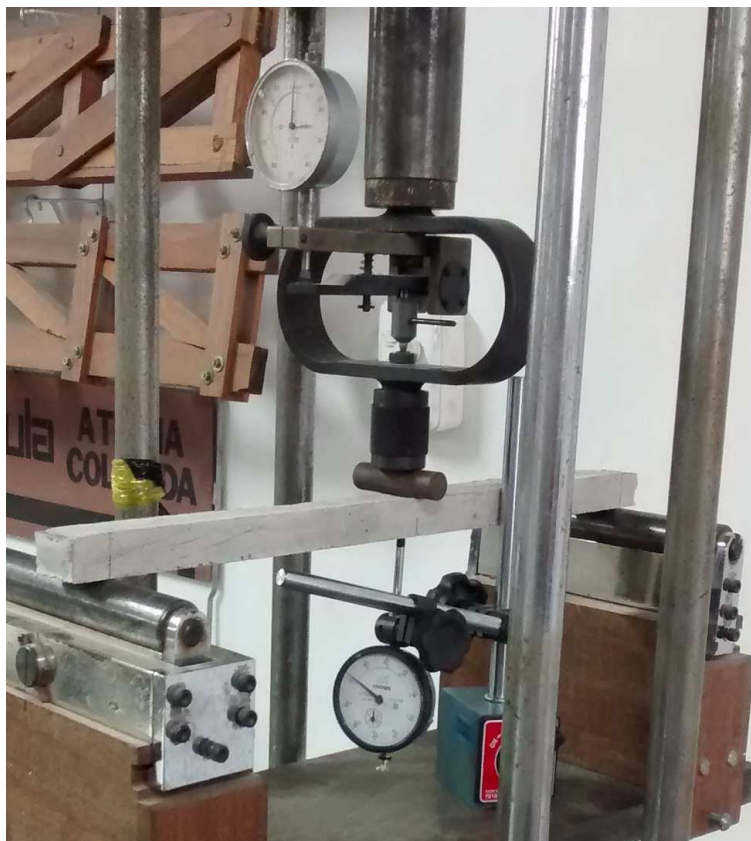
Figura 3.4 – Montagem do ensaio de flexão de barras de argamassa
