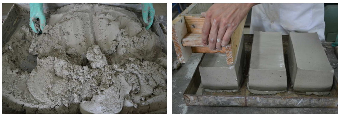
Figura 2.5 – Amassamento manual da mistura e moldagem dos blocos
