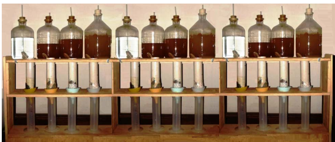
Figura 1 - Sistema montado para estudo da remoção de metais em colunas de lixiviação.
