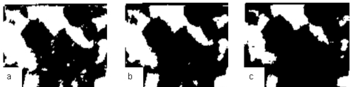
Figura 4 – Efeito da aplicação do filtro de limiar no fragmento da imagem LE da Figura 3, nos níveis de limiar 100 (a), 140 (b) e 200 (c).
