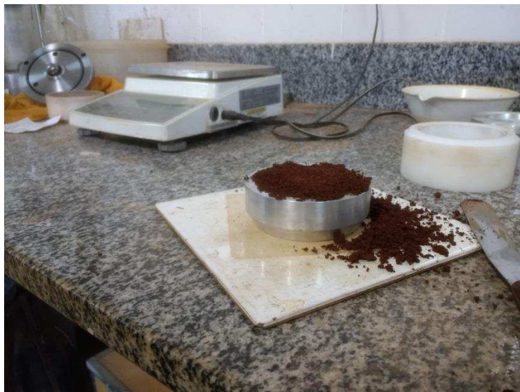
Figura 17: Superfície de solo excedente do anel sendo rasada
