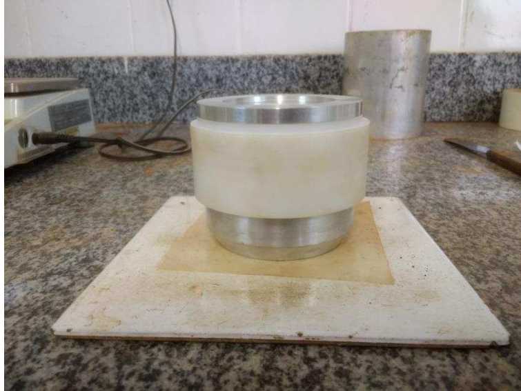
Figura 16: Solo compactado dentro do anel metálico
