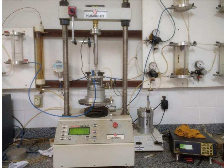
Figura 20: Execução do ensaio CRS com o uso de uma prensa do ensaio triaxial
