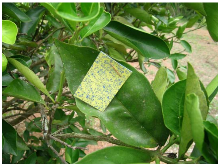
Figura 2 – Papel hidrossensível fixado na folha.
