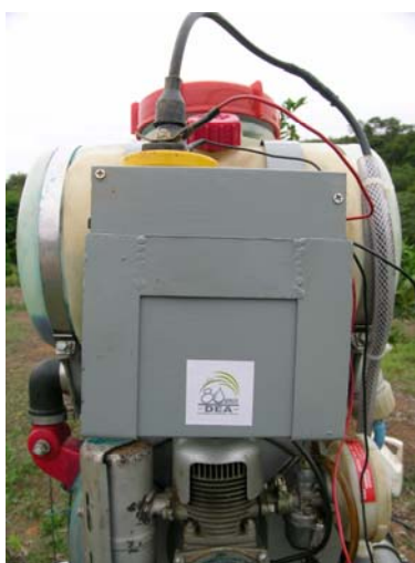
Figura 3 – Fonte de alta tensão adaptada na parte de trás do pulverizador.
