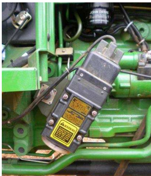
Figura 9 - Radar utilizado para medição da velocidade.
