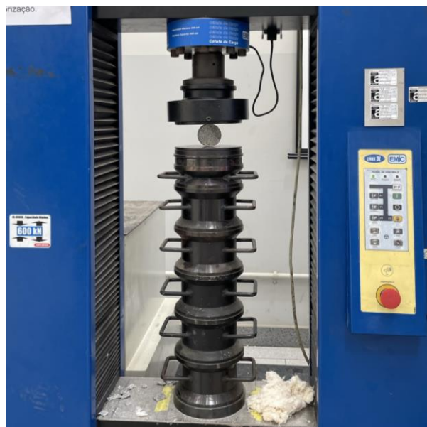
Figura 40 – Realização do ensaio de compressão diametral
