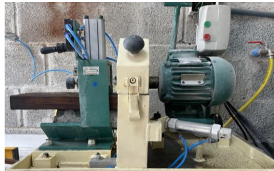
Figura 20 – Retificação das amostras
