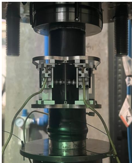
Figura 25 – Corpo de prova com extensômetros axiais e circunferencial acoplados
