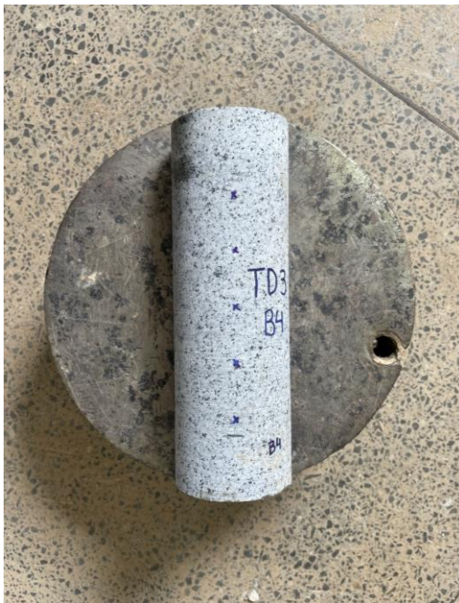
Figura 42 – Amostra com marcações delimitadas para as medições do martelo Schmidt
