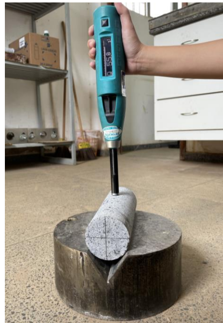
Figura 43 – Realização do ensaio do martelo Schmidt
