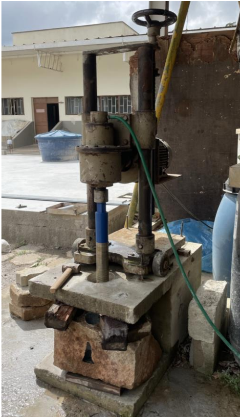
Figura 18 – Extração dos testemunhos de rocha
