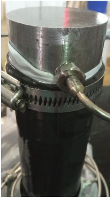
Figura 28 – Cap utilizado para drenagem do ar
