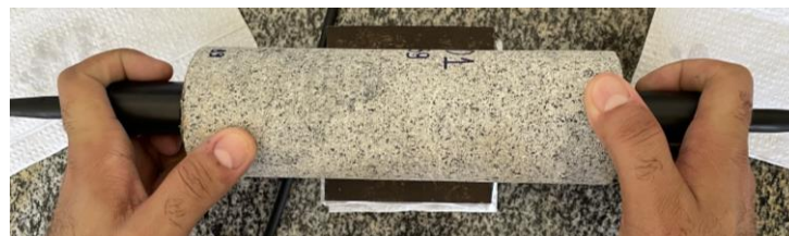
Figura 45 – Medição da velocidade de propagação de ondas: (a) compressivas e (b) cisalhantes
