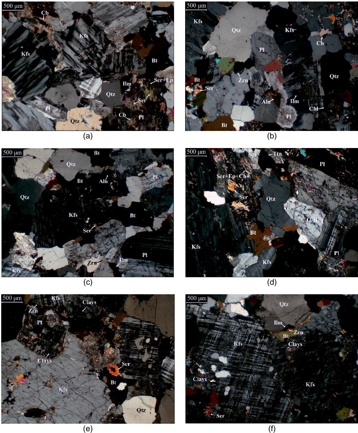
Figura 49 – Textura geral da rocha, com imagens em luz transmitida com os polarizadores cruzados com a objetiva de 2,5x. Aspectos das fases essenciais e acessórias observados nas lâminas: (a) W1(B4), (b) W2(B5) e (c) W2(B6), (d) relação entre fenocristais de plagioclásio e K-feldspato e a matriz além de cristal zonado de plagioclásio na matriz na lâmina W2(B9), e relação entre fenocristais de K-feldspato e a matriz nas lâminas (e) W3(B1) e (f) W3/W4(B1).
