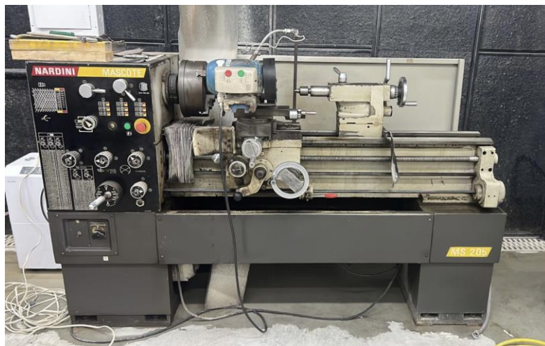
Figura 22 – Torno mecânico utilizado para usinagem em rochas
