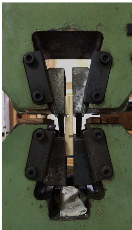
Figura 18. Ensaio de resistência ao cisalhamento realizado em máquina universal de ensaios mecânicos.
