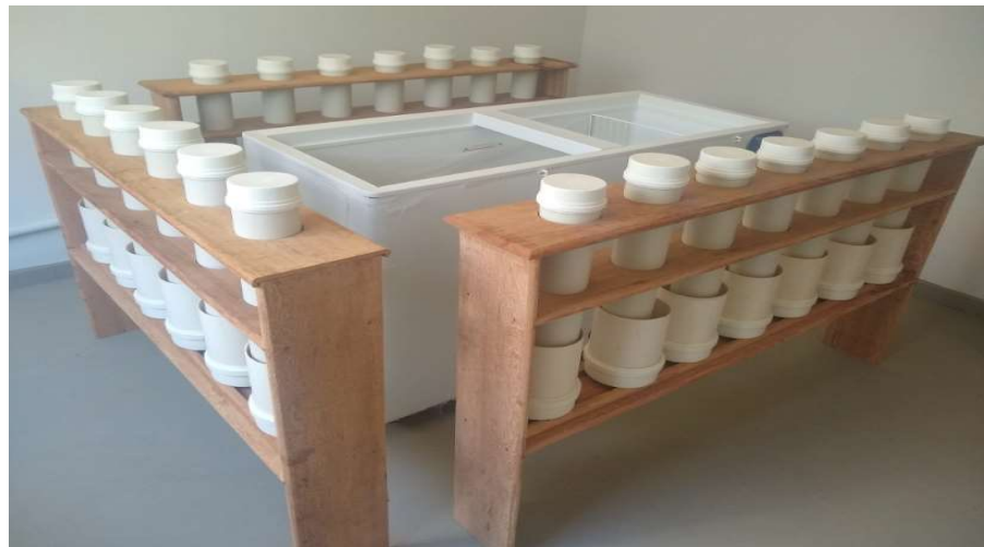
Figura 8 – Estrutura montada com os gasômetros, suporte de madeira e câmara
