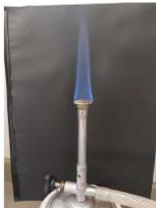
Figura 13 – Queima do biogás através do bico de Bunsen
