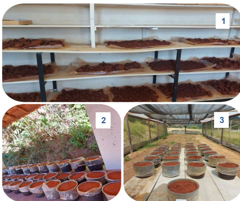
1- Solos secando ao abrigo do sol; 2- Vasos contendo 5 dm 3 de solo; 3- Solos na casa de vegetação.
