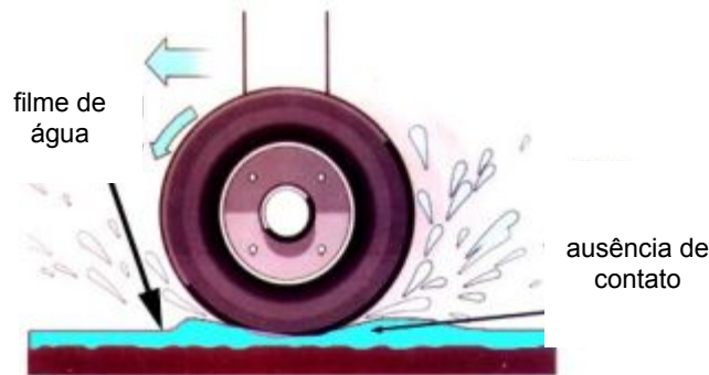
Figura 8 – Hidroplanagem dinâmica. Fonte: http://www.aviationshop.com.au/ (22/10/07)
