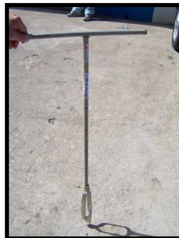
Figura 3.7 - Trado de aço manual para coletar amostras de solo.
