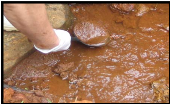
Figuras 3.6 - Amostragem de sedimentos com espátula de teflon.
