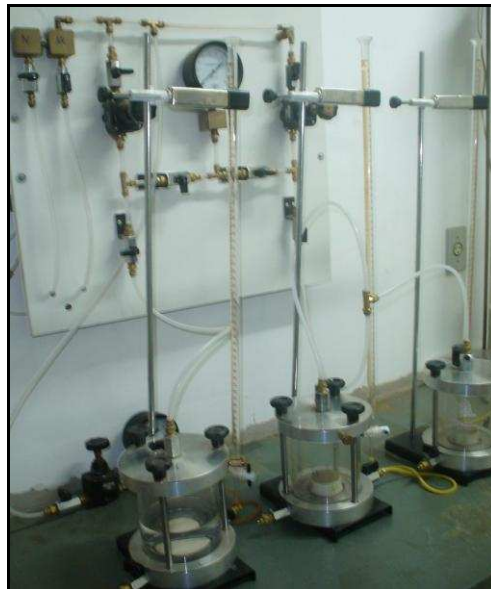
Figura 3.4: Placas de pressão usadas para determinação da curva característica (LEC/UFV).
