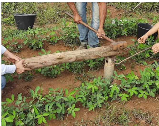
Figura 2. Demonstração da coleta de solo nas profundidades de 0-10 cm; 10-20 cm, 20-30 cm e 30-40 cm, aos 60 e 120 dias após a aplicação para avaliação da mobilidade do indaziflam no perfil do solo.
