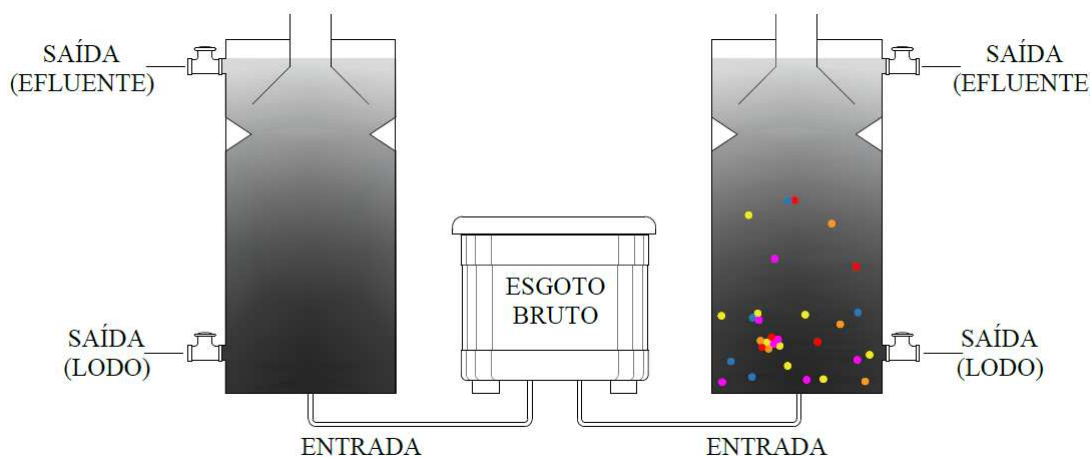
Figura 2. Esquema dos reatores anaeróbios de bancada do tipo UASB utilizados no experimento.
