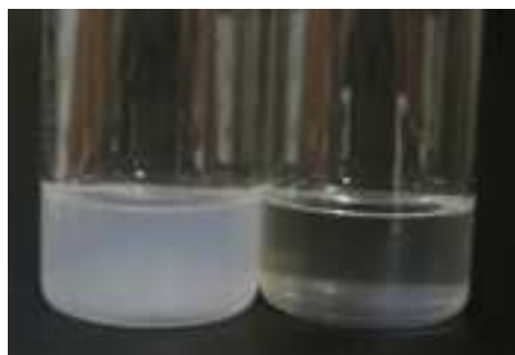
Figura 4.2: Solução cristalina (direita) representa região abaixo da curva da figura 4.1 e solução turva (esquerda) região acima da curva da figura 4.1.
