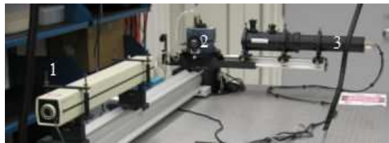
Figura 3.3: Um típico equipamento (correlacionador Brookhaven BI9000) de espalhamento de luz: (1) um laser de HeNe, (2) o porta amostra e (3) a fotomultiplicadora (detector).
