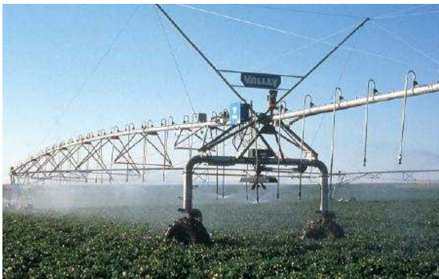
Figura 2.6: Vista parcial do braço de um sistema de pivô central com aplicação localizada de água na cultura do cafeeiro.
