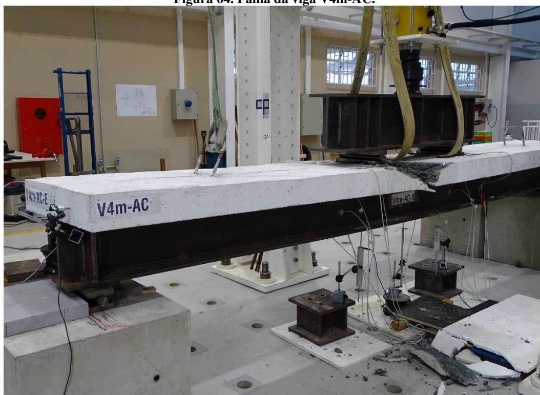
Figura 64. Falha da viga V4m-AC.
