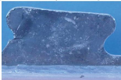
Figura 27. Falha no aço do conector puzzle (PZ).
