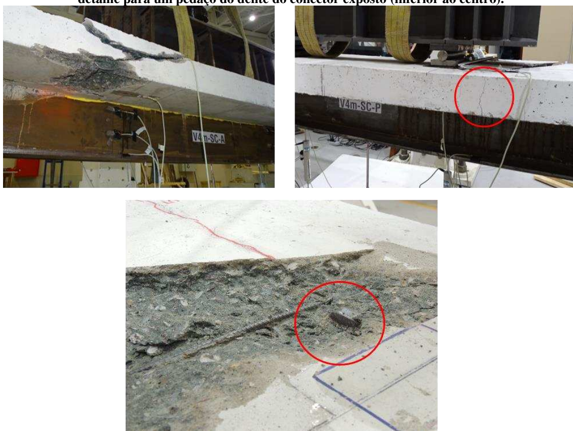
Figura 74. Detalhes da falha da viga V4m-SC: face anterior (superior à esq.); face posterior, com detalhe para uma fissura transversal na lateral da laje (superior à dir.); e vista superior da região de falha com detalhe para um pedaço do dente do conector exposto (inferior ao centro).
