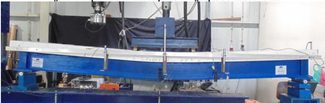
Figura 20. Aspecto deformado da primeira viga após o ensaio de flexão.
