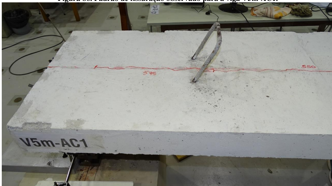
Figura 86. Padrão de fissuração observado para a viga V5m-AC1.
