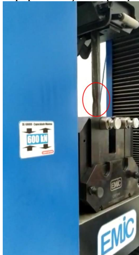
Figura 50. Ensaio de tração de uma amostra da chapa de aço da qual foram fabricadas as vigas, com destaque para a estrição do corpo de prova.
