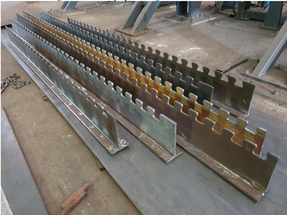
Figura 38. Perfis de aço após a soldagem na fábrica da CEDISA.
