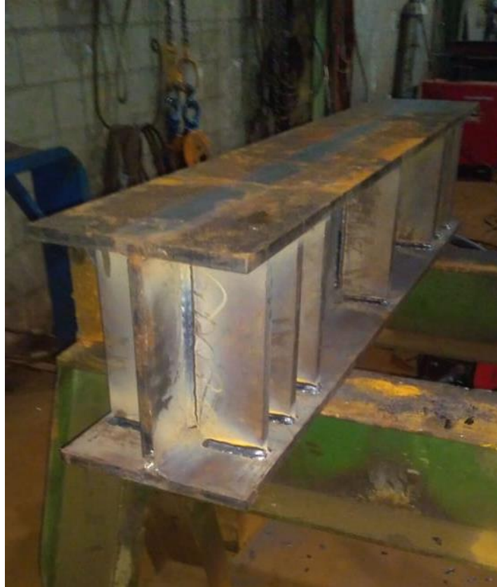
Figura 39. Perfil I para viga de aplicação do carregamento fabricado pela CEDISA.
