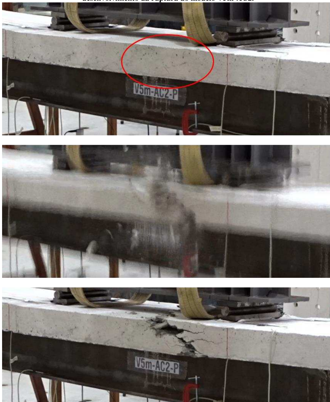
Figura 98. Quadros obtidos de uma filmagem em câmera lenta, que possibilita visualizar o desenvolvimento da ruptura do modelo V5m-AC2.
