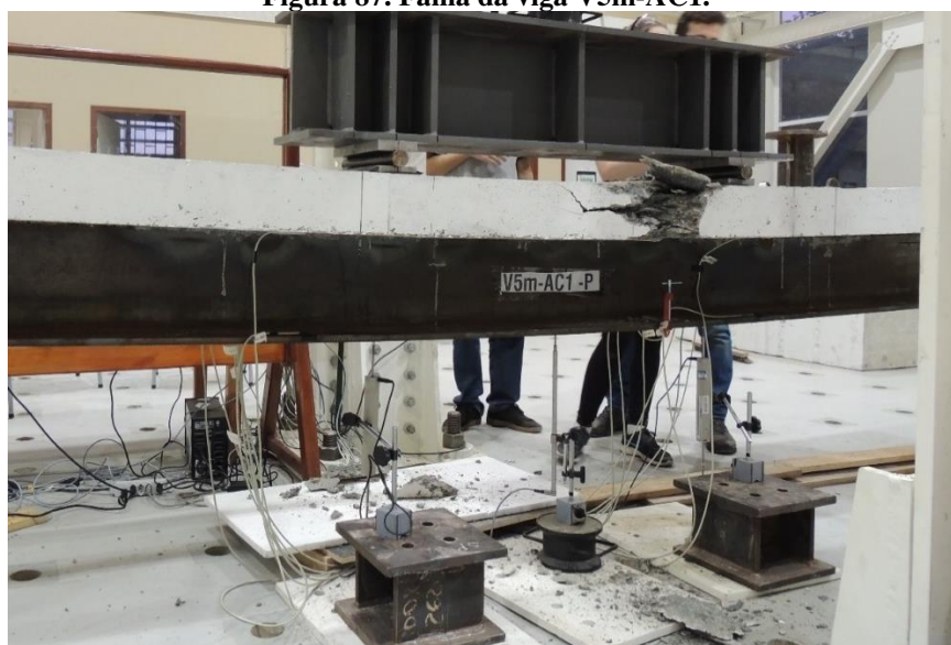
Figura 87. Falha da viga V5m-AC1.
