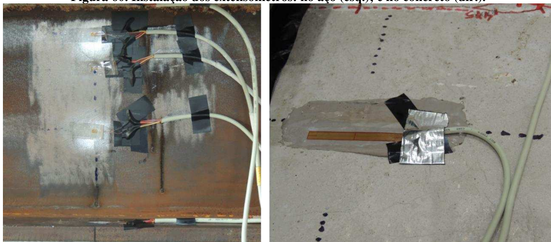
Figura 60. Instalação dos extensômetros: no aço (esq.); e no concreto (dir.).
