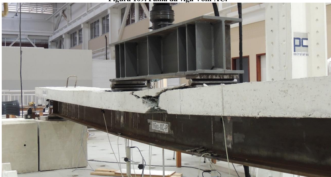
Figura 109. Falha da viga V6m-AC.
