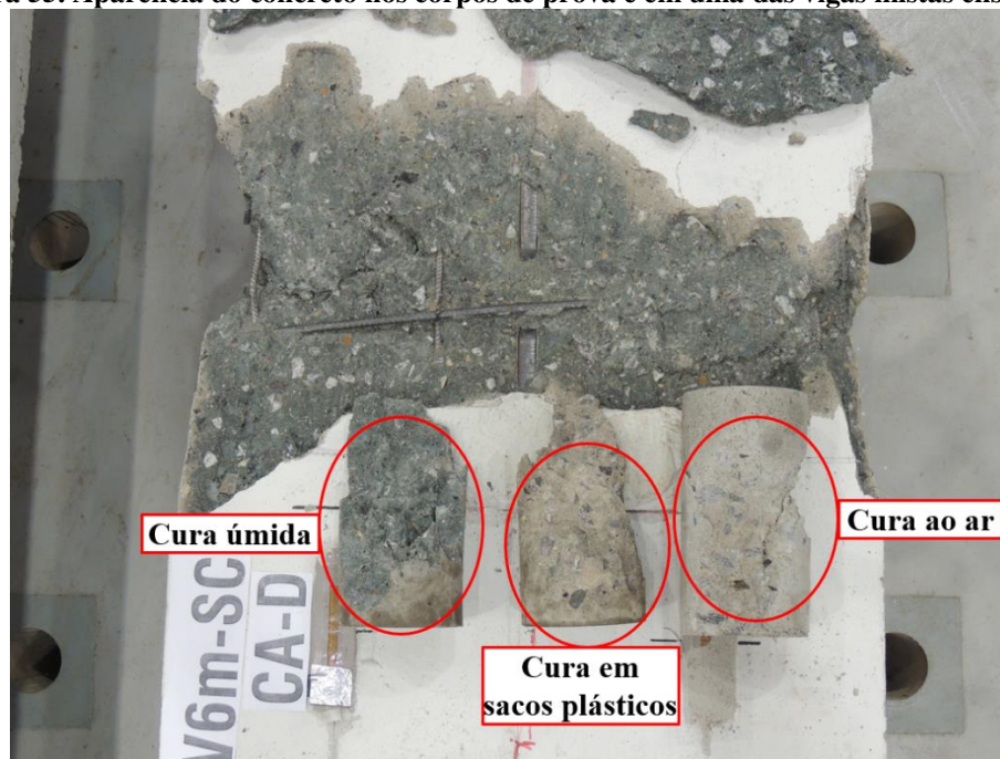
Figura 55. Aparência do concreto nos corpos de prova e em uma das vigas mistas ensaiadas.
