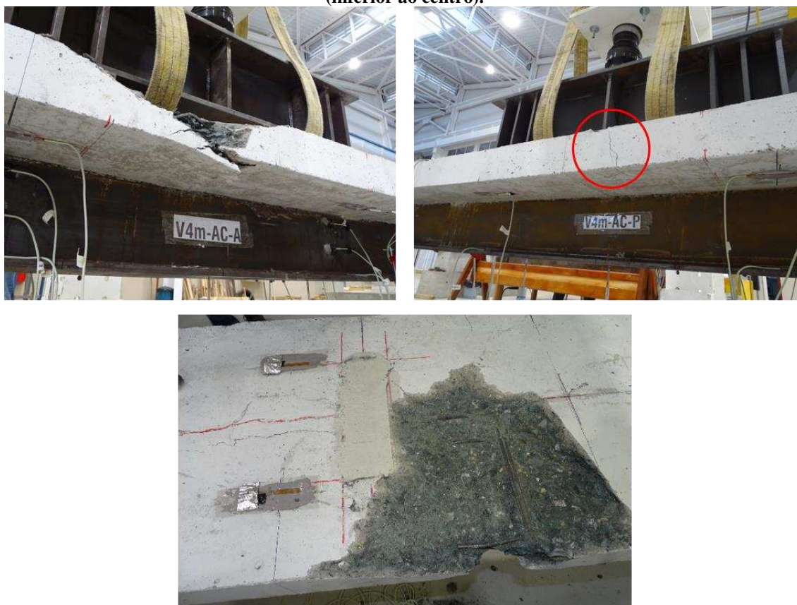
Figura 65. Detalhes da falha da viga V4m-AC: face anterior (superior à esq.); face posterior, com detalhe para uma fissura transversal na lateral da laje (superior à dir.); e vista superior da região de falha (inferior ao centro).
