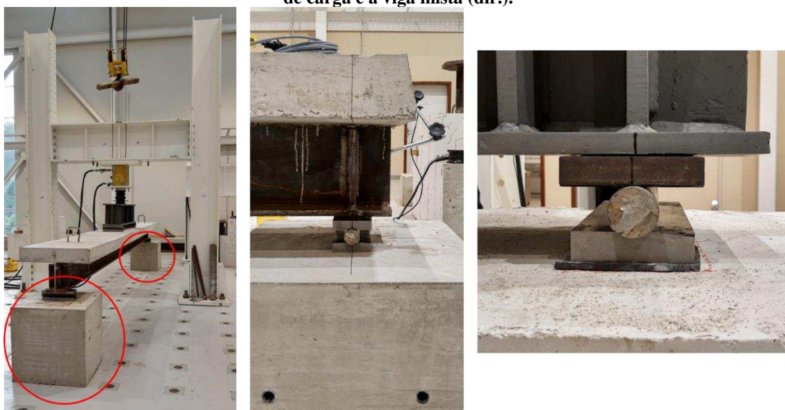
Figura 56. Sistema de apoio das vigas mistas: blocos de concreto em destaque (esq.); aparelho de apoio, sobre o bloco de concreto, apoiando a viga mista (centro); e detalhe do apoio entre a viga de distribuição de carga e a viga mista (dir.).
