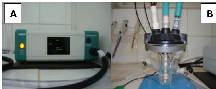
Figura 11. (A) Instrumentação utilizada: potenciostato/galvanostato \mu Autolab Type III e (B) célula voltamétrica com arranjo de três eletrodos.
