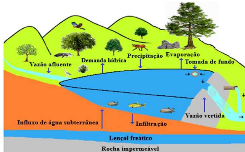
Figura 2. Representação esquemática dos diferentes fluxos que compõe o balanço hídrico de uma pequena barragem de terra. Fonte: Adaptado de (HABETS et al., 2018).
