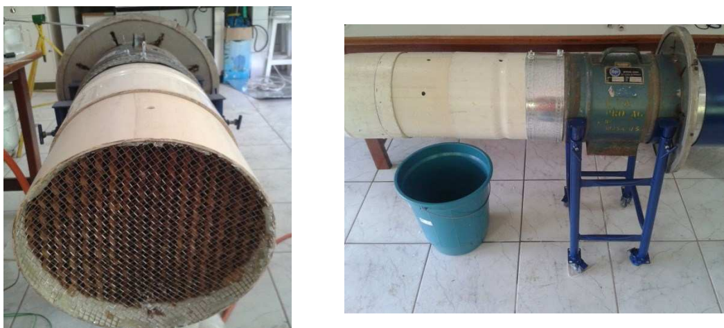
Figura 9. Sistema de resfriamento adiabático evaporativo por placas de celulose.
