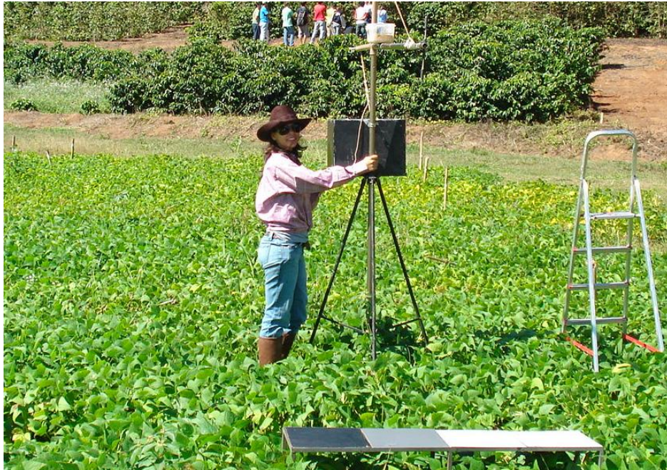
Figura 6 – Disposição da câmera com os painéis de calibração.
