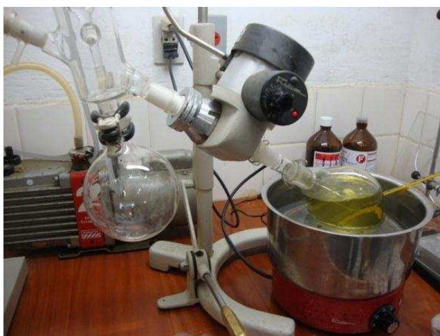
Figura 17: Evaporador rotativo iniciando o processo de destilação da mistura (coloração amarela – balão em Banho-Maria).
