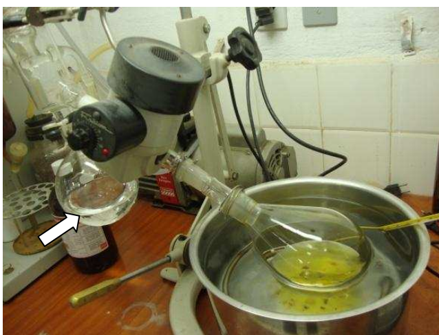
Figura 18: Evaporador rotativo finalizando o processo de destilação, contendo óleo no balão em Banho-Maria e hexano recuperado (seta).
