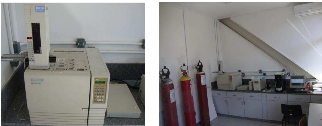
Figura 21: Cromatógrafo gasoso do Laboratório de Nutrição Experimental do Departamento de Nutrição do CCB da UFV.
