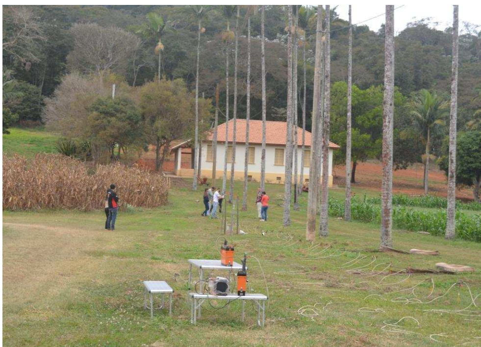
Figura (II) 1: Eletrodos instalados em uma das seções ensaiadas - Método do caminhamento elétrico.
