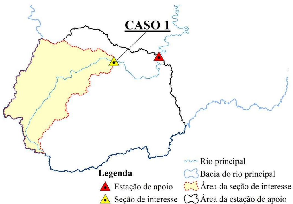
Figura 1.3. Caso 1 de posição relativa da seção de interesse em relação à estação de apoio.
