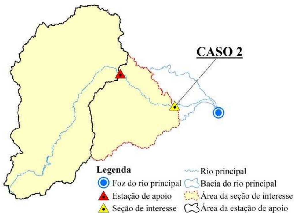
Figura 1.4. Caso 2 de posição relativa da seção de interesse em relação à estação de apoio.
