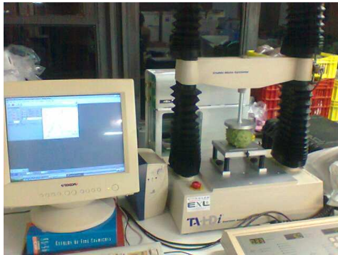
Figura 1.1 - Aparelho Universal de Testes, TA.HD Texture Analyser, Stable Micro Systems utilizado para análise de textura.
