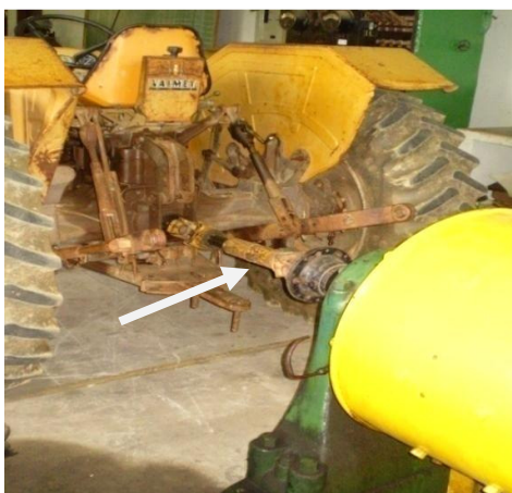
Figura 3. Acoplamento da TDP do trator ao dinamômetro por meio de um eixo cardã.
