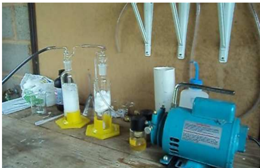
Figura 31 - Sistema de absorção do ácido clorídrico.
