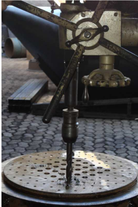
Figura 20 - Processo de execução dos furos nos defletores e espelhos.
