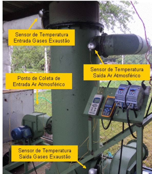
Figura 26 - Pontos de tomada das temperaturas de entrada e saída dos gases de exaustão e do ar.
