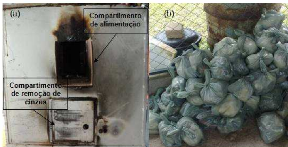
Figura 25 - Alimentação do incinerador: (a) alimentação de resíduos e compartimento de remoção de cinzas; e (b) cargas de 100 g de resíduos.
