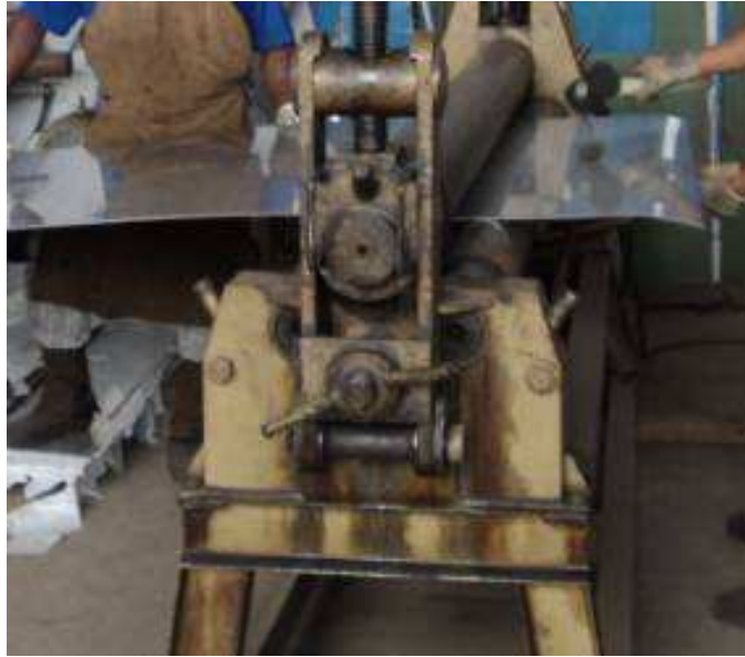
Figura 19 - Processo de conformação mecânico por calandragem.
