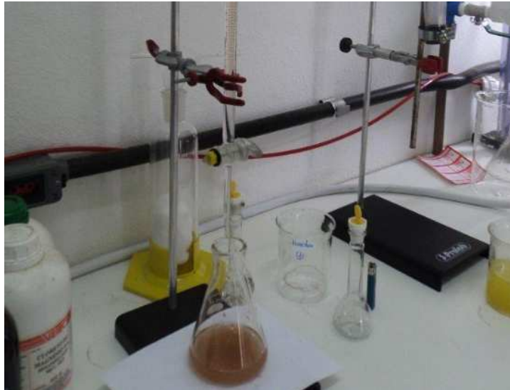
Figura 32 - Medição da quantidade de cloreto dos gases.
