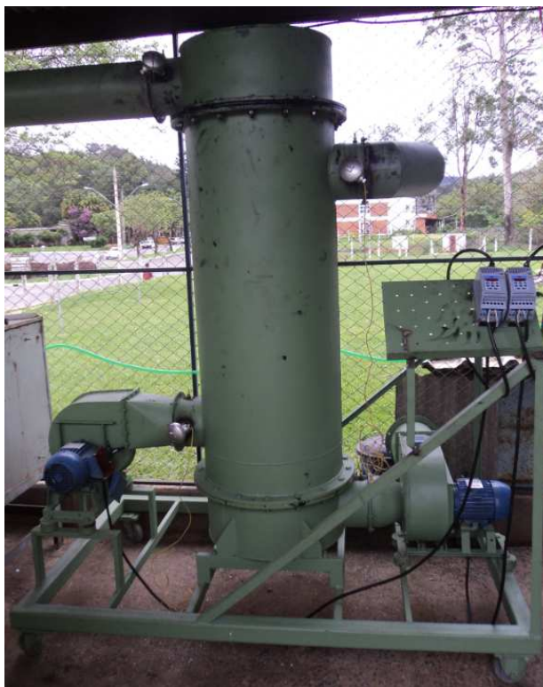
Figura 18 - Sistema de recuperação de calor.
