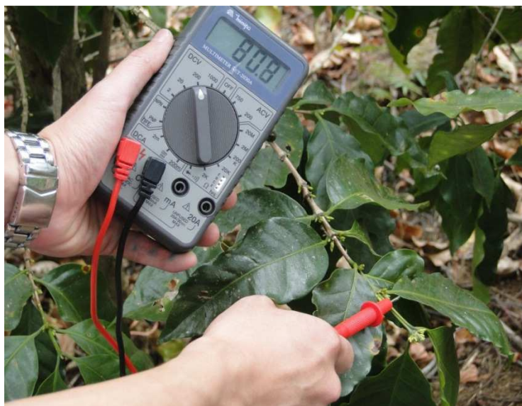
Figura 9. Monitoramento de tensão elétrica na planta.
