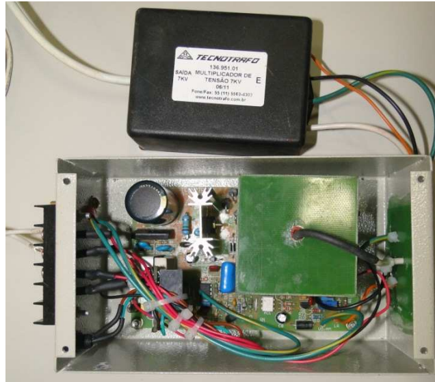
Figura 7. Fonte de alta tensão corrente contínua, utilizado para eletrificar o alvo.
