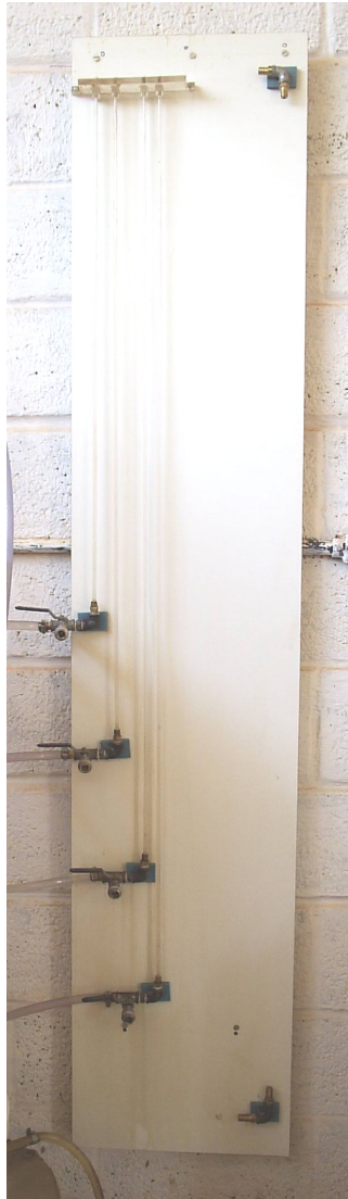
FIGURA 5 – Vista do painel piezométrico.
