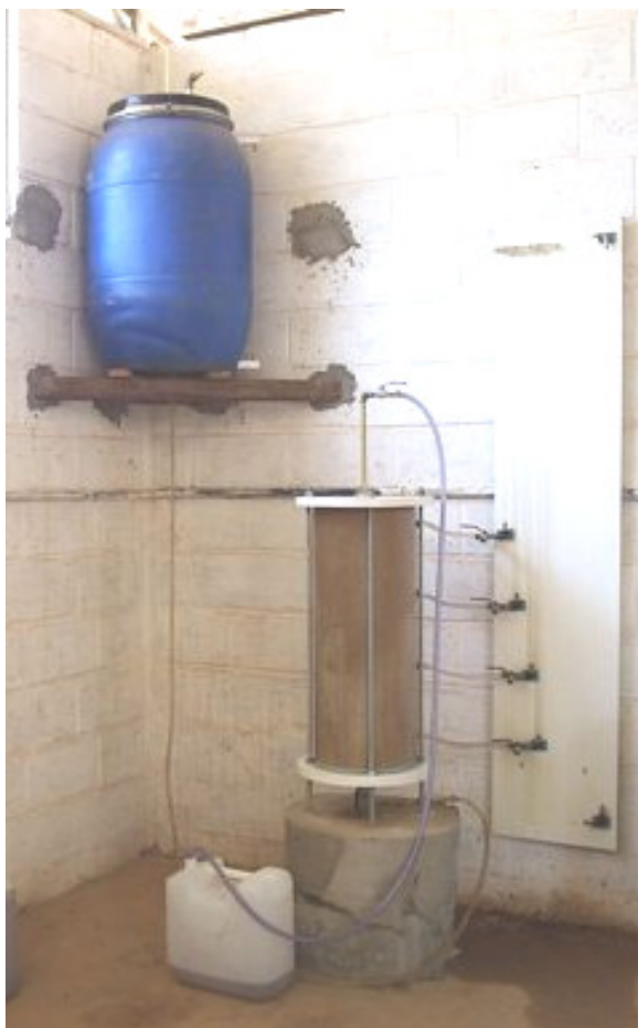
FIGURA 9 – Coleta de percolado durante a realização do ensaio de capacidade de campo.
