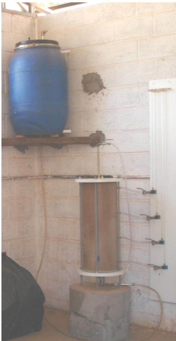
FIGURA 7 – Equipamento completo: reservatório, permeâmetro e painel piezométrico.
