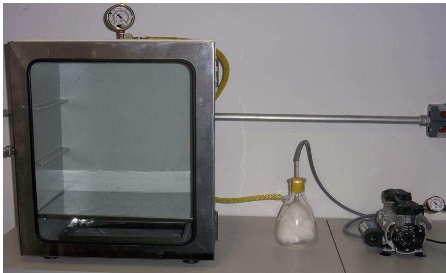
Figura 6. Esquema do equipamento utilizado para realizar a impregnação a vácuo.
