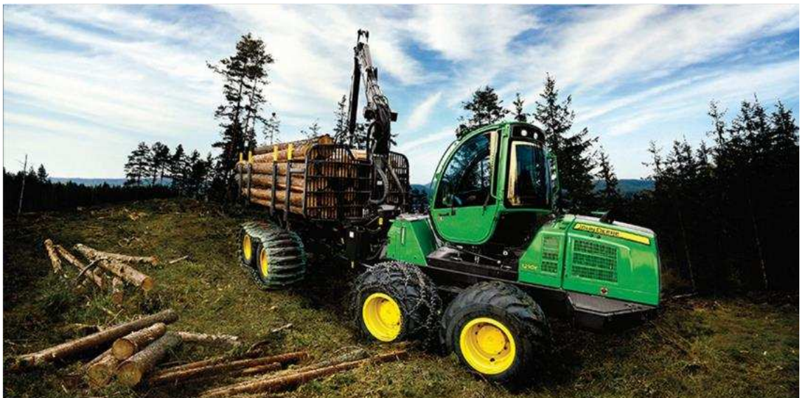
Figura 1. Máquina de extração florestal forwarder .
