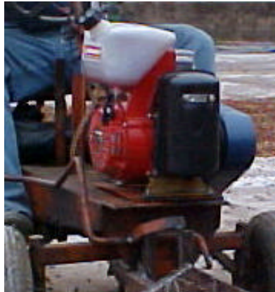
FIGURA 8 - Motor ciclo Otto instalado no microtrator MCI
