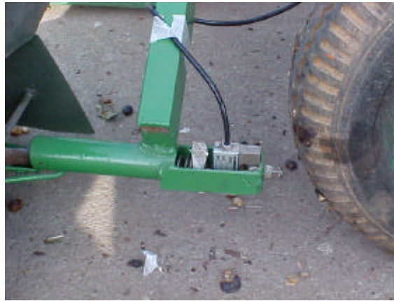
FIGURA 3 - Célula de carga para medição do esforço de revolvimento
