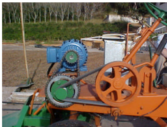
FIGURA 3 - Motor elétrico CA instalado no microtrator MCA.
