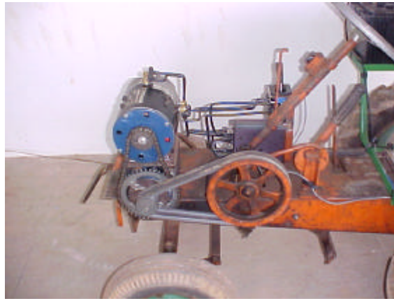
FIGURA 5 - Motor elétrico CC instalado no microtrator MCC.
