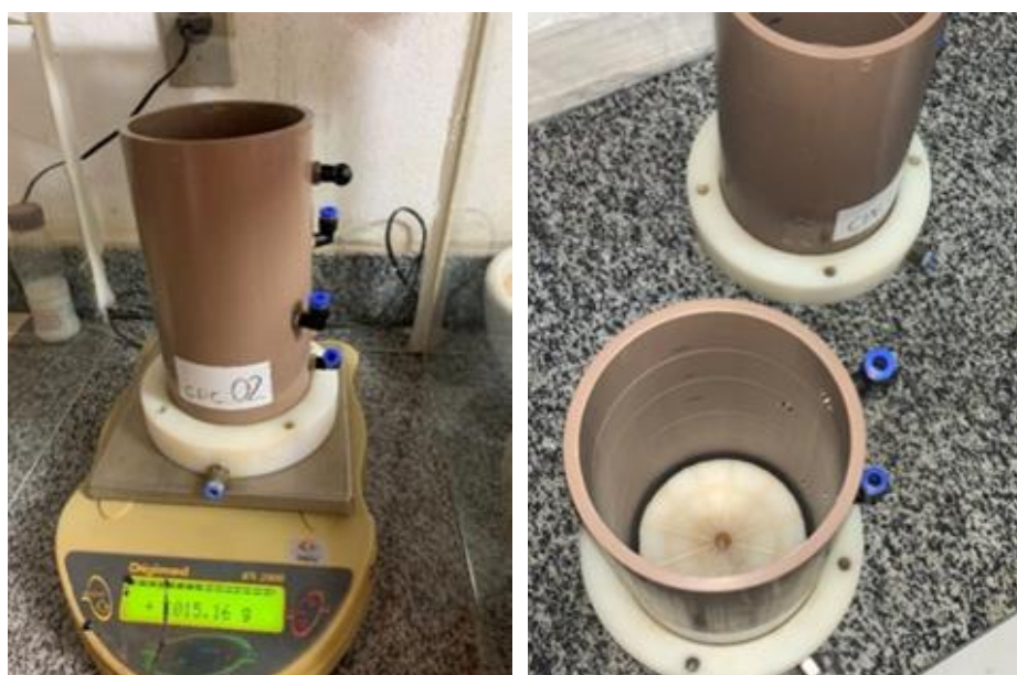
Figura 26 - Fotos do molde construído para a nova célula de percolação proposta.
