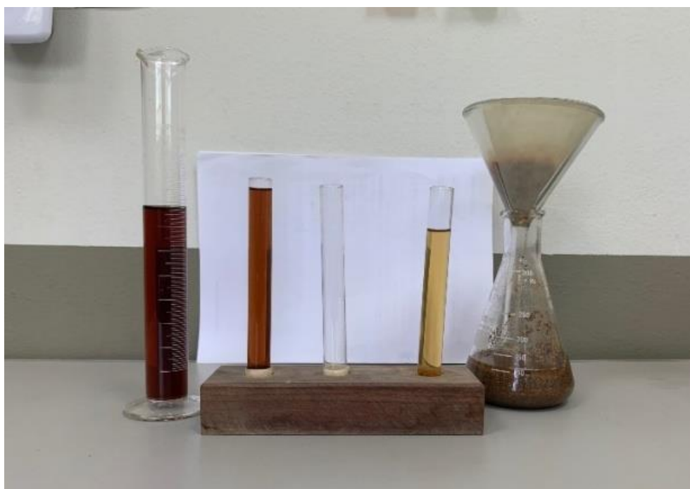
Figura 40 - Resultados do ensaio de determinação de impurezas orgânicas em agregados.
