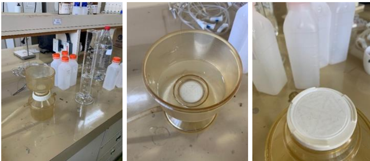
Figura 32 - Equipamentação de filtragem utilizado no ensaio de sólidos em suspensão.
