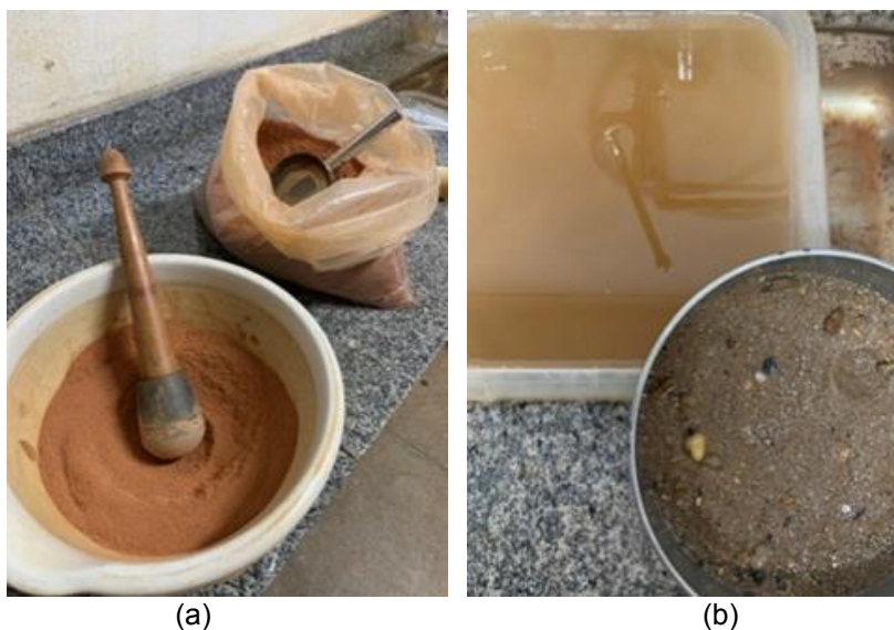
Figura 28 - Fotos da preparação do (a) material base – destorroamento, e do (b) material do filtro - lavagem.
