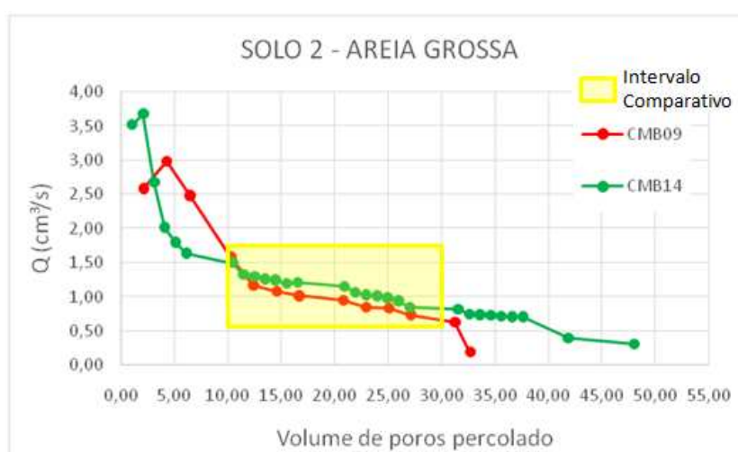
Figura 52 - Curva de percolação do Solo 2 com areia grossa.
