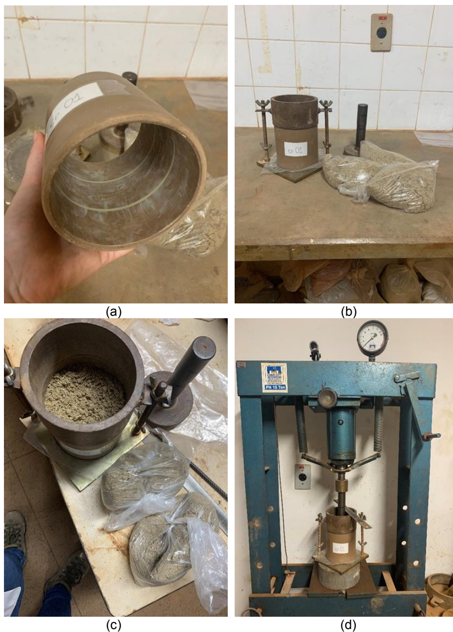
Figura 21 - (a). Molde do corpo de prova preparado com bentonita nos frisos. (b). Aparelhagem e solo preparado e devidamente porcionado para compactação estática. (c). Compactação estática em andamento. (d). Corpo de prova sendo moldado na máquina de compressão estática.
