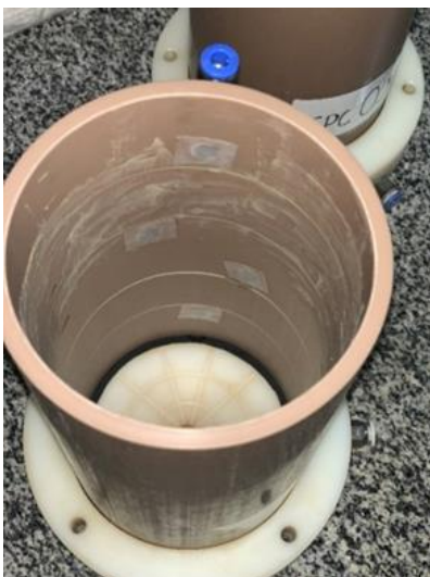
Figura 29 - Foto do molde do corpo de prova devidamente preparado com bentonita e papel filtro
