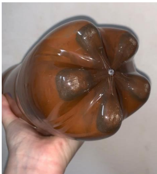
Figura 57 - Foto das partículas decantadas do fluido percolado no ensaio Rejeito com areia grossa.
