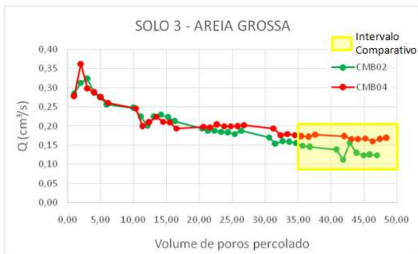
Figura 50 - Curva de percolação do Solo 3 com areia grossa.
