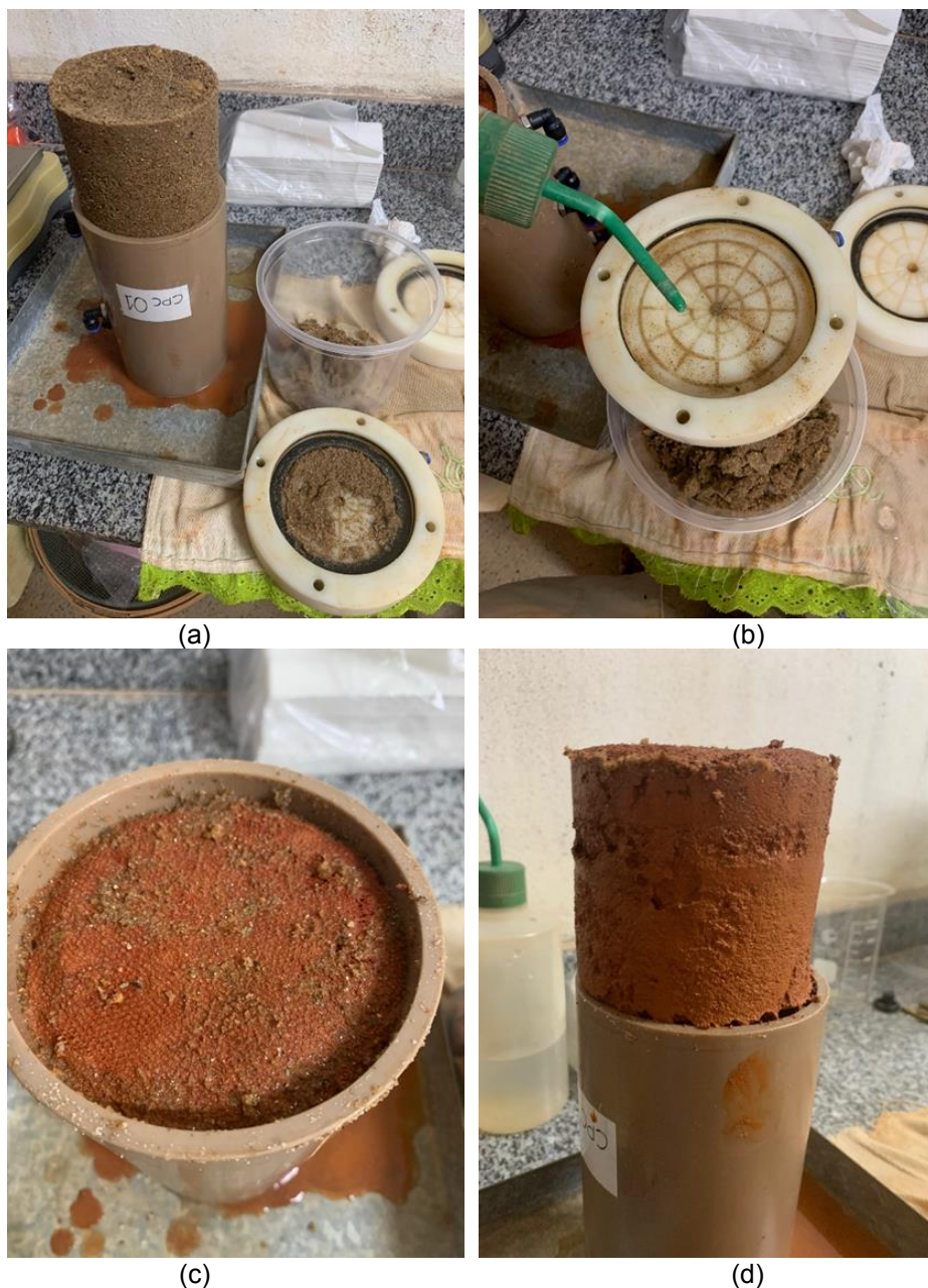
Figura 34 - (a) Retirada do material filtro do corpo de prova. (b) Lavagem do material filtro retido na base do corpo de prova. (c) Interface de contato material filtro e material base dividida com tecido de tule. (d) Retirada do material base do corpo de prova.
