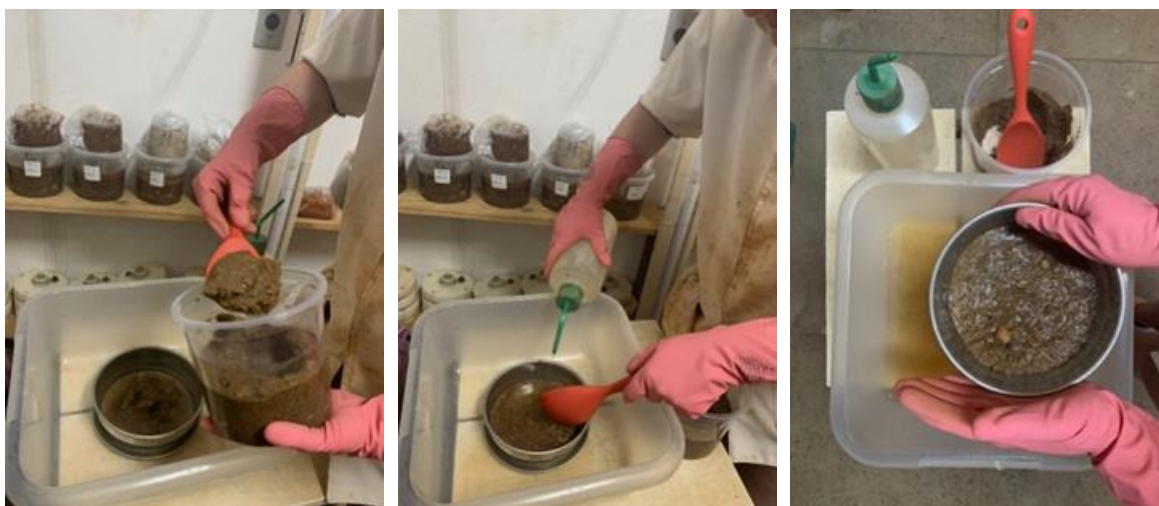
Figura 35 - Fotos do processo de lavagem do material filtro extraído de um corpo de prova ensaiado.
