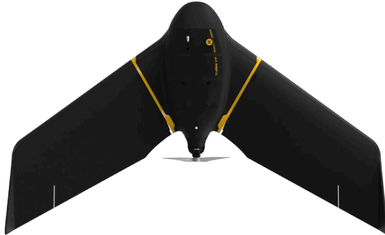
Figura 2. Representação de um modelo de RPAS de asa-fixa: eBee X da senseFly . Fonte: SenseFly.
