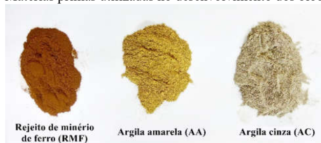
Figura 1.1 – Matérias primas utilizadas no desenvolvimento dos blocos cerâmicos.
