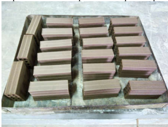
Figura 2.2 – Exemplos conformados por extrusão após a etapa de secagem ao ar.
