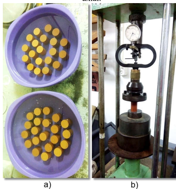
Figura 1.4 – Caracterização dos exemplares: a) imersão em água fria para determinação da absorção de água e porosidade aparente; b) ensaio de determinação da resistência à compressão axial.
