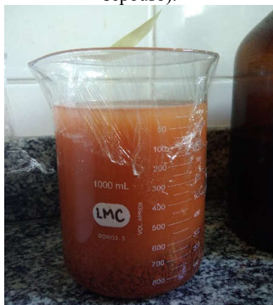
Figura 2.4 – Ensaio de solubilização feito com a amostra de blocos sem rejeito (primeiro dia de repouso).
