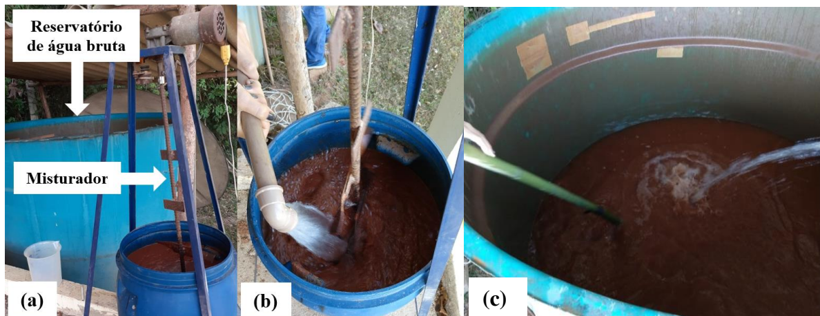
Figura 14 - (a) Reservatório de água bruta, bombona e dispositivo misturador utilizados para preparar a suspensão a ser adicionada ao reservatório; (b) água bruta sendo adicionada à bombona; (c) mistura da água dentro do reservatório após adição da suspensão de solo preparada na bombona.
