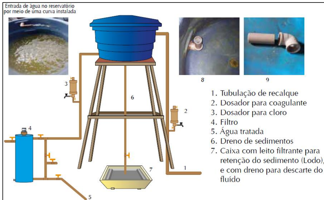
Figura 1 - Ilustração esquemática da Salta-z para tratamento de águas superficiais.
