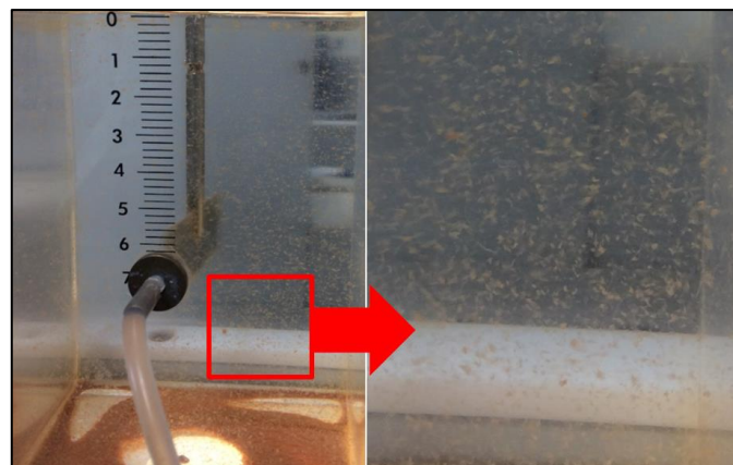
Figura 41 - Flocos observados em ensaio de jarro.
