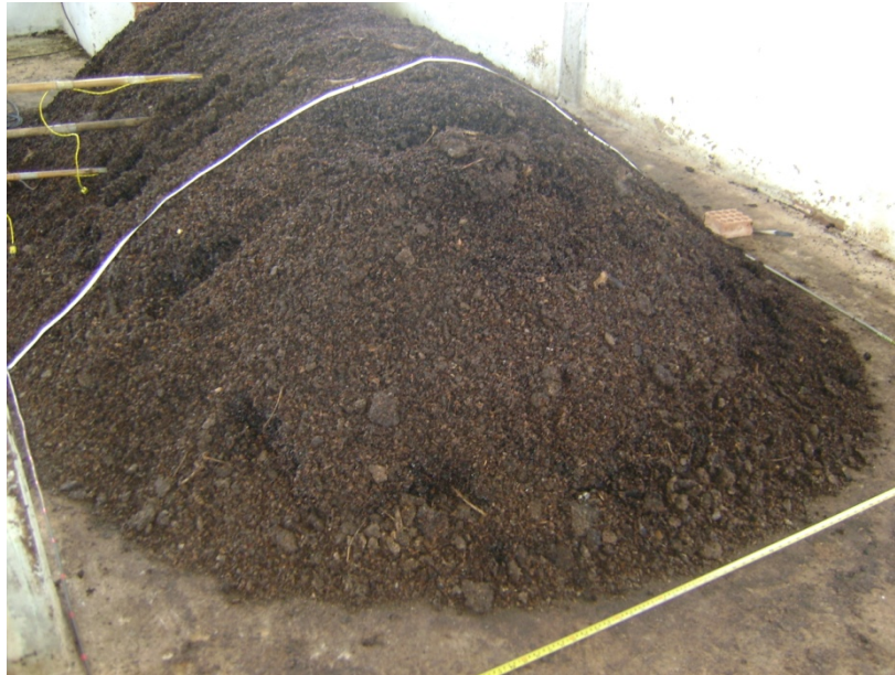
Figura 9. Vista de como foram feitas as medidas das leiras para obtenção da espessura da camada de material.
