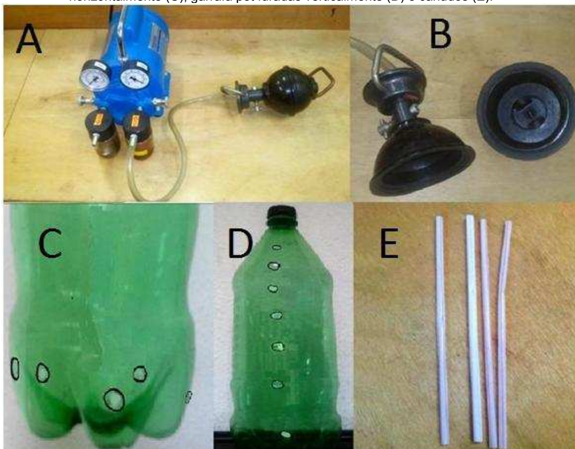
Figura 13 – Bomba de vácuo (A), hemisférios de Magdeburgo (B), garrafa pet furadas horizontalmente (C), garrafa pet furadas verticalmente (D) e canudos (E).
