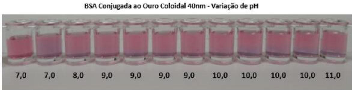
Figura 35: Avaliação visual das condições de adsorção da proteína BSA e ouro coloidal 40nm mediante alteração do pH. Para verificar a interferência do pH ao processo de adsorção, volumes variados (0-10 \mu L) de K_2CO_3 0,1 M foram adicionados ao conjugado. O pH ótimo foi definido como o correspondente volume de K_2CO_3 (0,1M) que manteve a cor da solução vermelha, sem alteração (vermelha para azul/roxa), o que indica conjugação sem formação de agregados. Fonte: Dados da pesquisa
