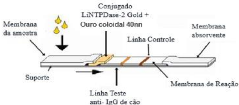
Figura 6 - Diagrama esquemático de uma tira de LFIA - modelo 1. Agente de reação da linha teste Anti- IgG de cão e conjugado rLicNTPDase2-Gold + ouro coloidal 40nm Fonte: Adaptada de O'FARRELL, 2013.
