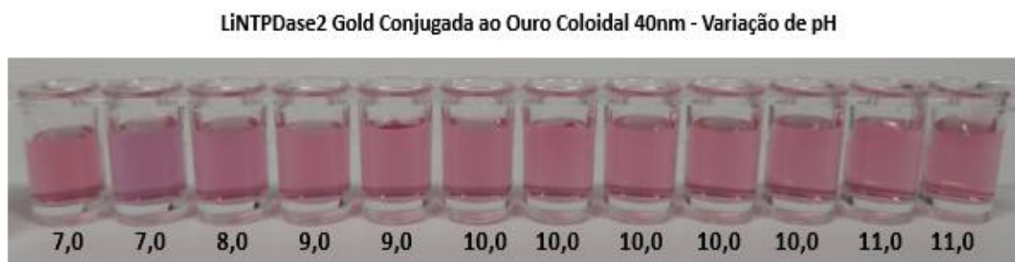
Figura 29: Avaliação visual das condições de adsorção mediante alteração do pH. Para verificar a interferência do pH ao processo de adsorção, volumes variados (0-10 \mu L) de K_2CO_3 0,1 M foram adicionados ao conjugado. O pH ótimo foi definido como o correspondente volume de K_2CO_3 (0,1M) que manteve a cor da solução vermelha, sem alteração (vermelha para azul/roxa), o que indica conjugação sem formação de agregados. Fonte: Dados da pesquisa
