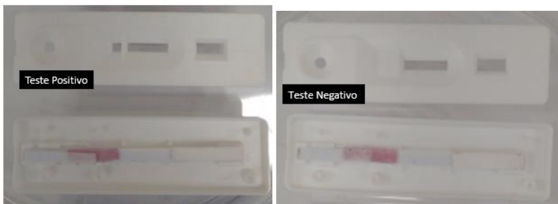
Figura 39: Resultado do ensaio realizado com tira LFIA modelo 1. O modelo 1 da tira LFIA apresenta como imobilizado na linha teste anti-dog IgG, e como conjugado impregnado e seco na fibra de vidro a rLicNTPDase2-Gold + ouro coloidal 40nm. A formação de uma marcação vermelha circular indica um resultado reagente (positivo) e ausência dessa marcação um resultado não reagente (negativo). No teste positivo foi utilizado amostra positiva para LVC e no teste negativo amostra negativa para LVC, em ambos testes foi usado solução diluente Tris-HCL. Fonte: Dados da pesquisa
