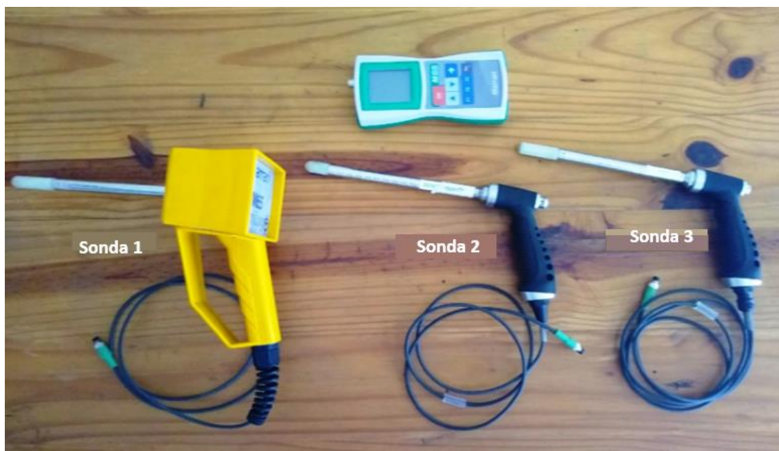
Figura 3 - Sondas utilizadas para medição do teor de umidade a partir do aparelho UMILOG-M65.
